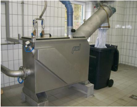
Speziell für diesen Einsatzbereich haben wir die PWL HELIXSIEBE entwickelt. Diese Maschine erfüllt die für diese Einsatzfälle notwendigen Anforderungen wie z.B. Kompaktheit, geschlossene Bauweise, hohe Abscheideleistung, Rechengutauswaschung und Rechengutentwässerung in einer Einheit.
